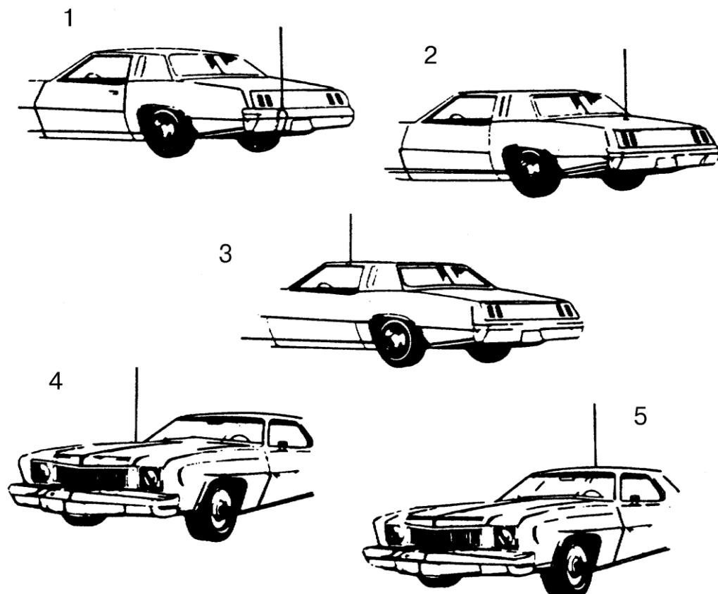
Рис. 6. Типичные места установки автомобильных антенн.
