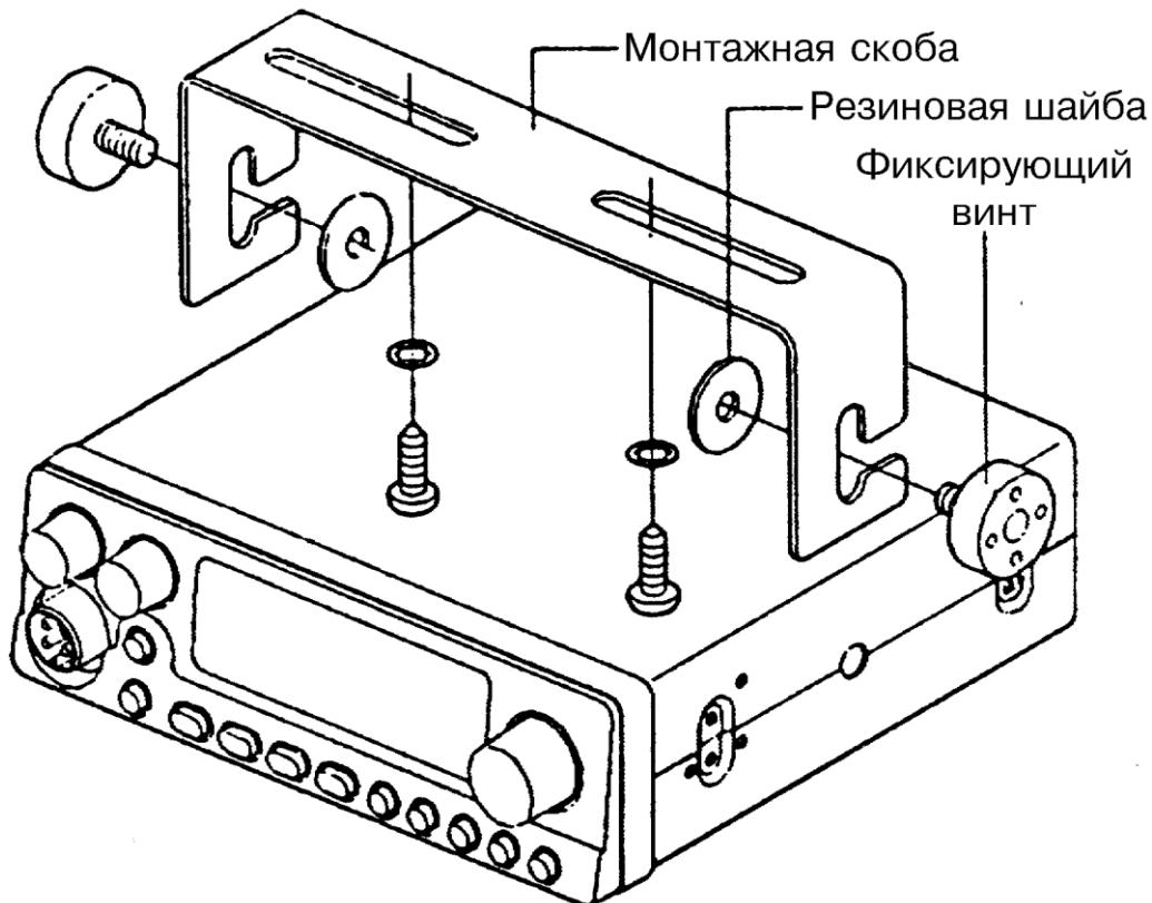
Рис.2. Крепление радиостанции при помощи монтажной скобы.
