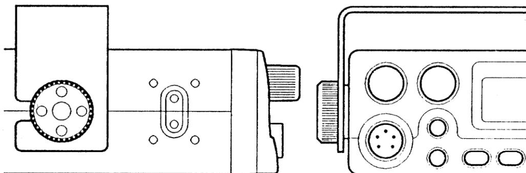
Рис. 3. Крепление радиостанции фиксаторами.
